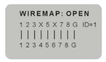
Presione - en el costado para renovar la prueba, y presione **"ENTER"** para ingresar al menú principal. El cable se abre en circuito en una distancia corta.
