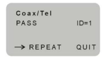
Presione "ENTER" para renovar la prueba; o presione ▲ ▼ para regresar al menú principal y luego seleccione "SALIR" y presione "ENTER".
