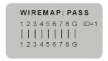
En esta imagen, la primera fila de figuras representa el puerto de "RJ45", "ID = 1" representa el número de adaptador y conmutador distantes. "I" representa la línea de conexión del puerto distante y el puerto principal, la segunda fila de figuras representa el puerto del principal "RJ45".
