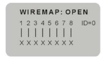
Presione ▲▼ para renovar la prueba; O presione "ENTER" para regresar al menú principal.
